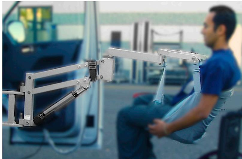
La Gruetta Solleva Persone viaggia nel bagagliaio del veicolo e viene utilizzata solamente nel momento del trasferimento della persona dalla seduta della carrozzina al sedile dell'autovettura e viceversa. Il dispositivo viene alimentato collegandolo alla batteria della macchina e una volta conclusa l'uscita viene portato in casa.
